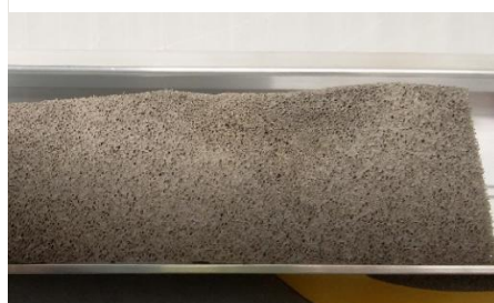
Rys. 43 Uszczelka rozprężna po rozprężeniu
